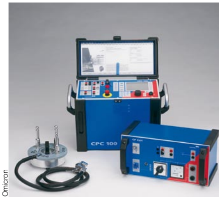
Bild 5 Für die Messung werden ein Prüfgerät zur Erzeugung von variablen Frequenzen, eine Kopplungseinheit sowie eine Erdungseinheit für den Anschluss an die Freileitung benötigt.
