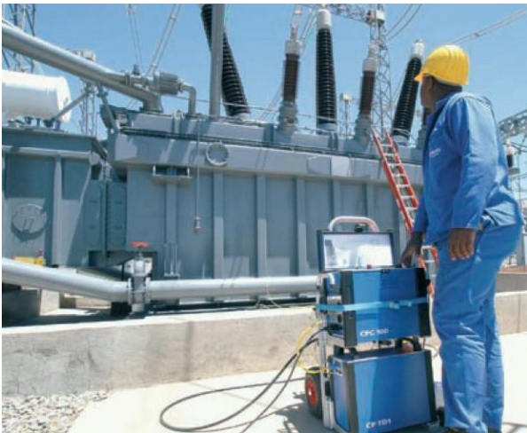
Bild 2 Vor-Ort-Messung der dielektrischen Antwort von Hochspannungsdurchführungen
