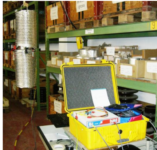
Bild 11 Kombinierte FDS-PDC Messung an einer RIP Durchführung mit einem Aluminiumschirm zur Störunterdrückung
