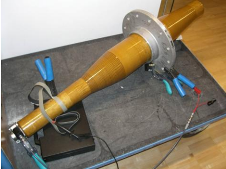
Bild 17 Falsch gelagerte 145kV RBP Öl-Öl Durchführung
