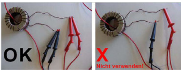
Bild 4: Korrekte vierpolige Messung
