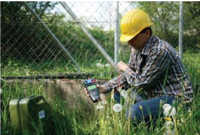
Mesure de Tension de Contact utilisant le CP AL1, CPC 100 et le CP CU1
