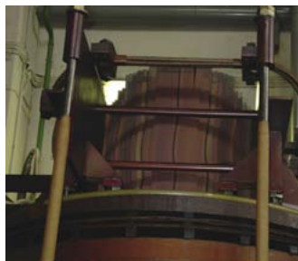
Circuit magnétique déformé
