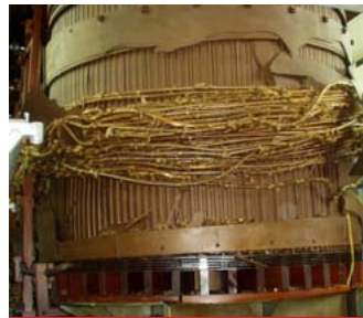
Enroulement de réglage écroulé
